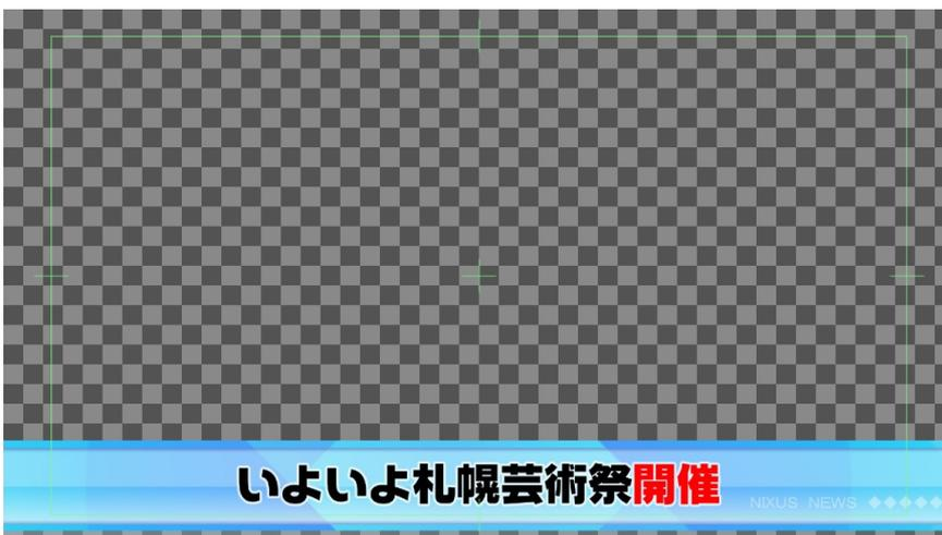
このエリアがテロップを作成するエリアです。ここで、オブジェクトの配置やサイズの修正などを確認しながら行えます。画面内の緑色の線は「セーフティ」と呼ばれ、作成したテロップをテレビで見た際にあらゆるテレビで表示されるエリアになります。放送局によってこのエリアの範囲は異なりますが、テロップ作成ソフトでは、5%に設定してあります。このセーフティは【表示】メニューの【セーフティエリア設定】の【詳細設定】から設定できます。
